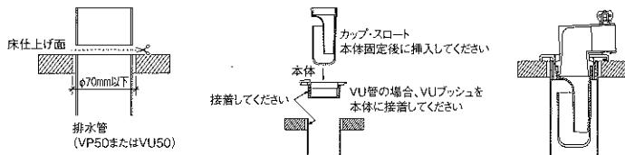
③本体よりスライドカバーとホースジョイントを取り外し、排水管と本体に接着剤を塗布し、本体を排水管に差し込んでください。(VU管に接着する場合にはVUブッシュを本体に接着してからブッシュ外周部に接着剤を塗布し、本体を排水管に差し込んでください。)
