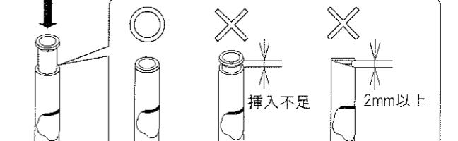
●インコアと切断端面が2mm以上ある場合は、再度樹脂管を必ず直角に切断し直して下さい。
