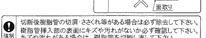
●切断後樹脂管の切屑・さざれ等がある場合は必ず除去して下さい。
