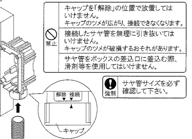
④取外しは、水栓ボックスのキャップを解除位置まで回転させてから、サヤ管を引き抜いて下さい。
