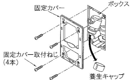
**注意** 固定カバー取付ねじを締めすぎないように注意して下さい。固定カバーが変形しカバーが正常に取付けられなくなるおそれがあります。
