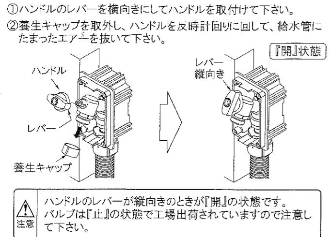
③ハンドルを時計回りに止まるまで(90°)回して下さい。この状態で耐圧検査を実施して下さい。
