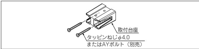
2. タッピンねじまたは、タッピンねじとAYボルトで取付台座を取り付けます。
