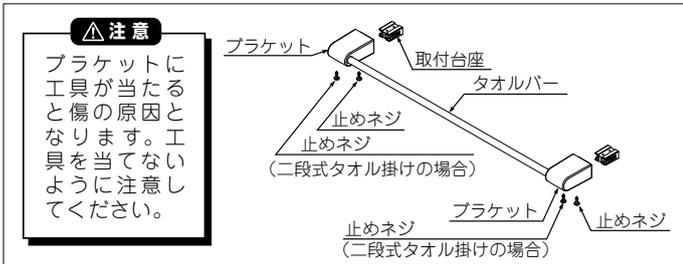
3. 取付台座にリング本体を差込み、止めネジで締め付けます。
