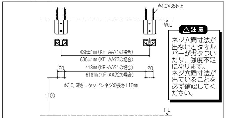
1. 取付ける壁の施工位置に合わせて取付台座を取付面に当て、各取付台座の左右2ヶの取付穴の位置をけがきます。つづいて、けがき穴位置に下穴をあけます。
